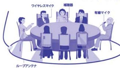
\*磁気誘導ループとは左のように聴覚障害者用の補聴器を補助する放送設備のこと。磁界を発生させるワイヤーを輪のように這わせることから、通称「磁気ループ」と呼ばれる。国際的には「ヒヤリングループ」という名称になっている。
